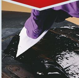
2-к. состав для ремонта конвейерных лент и РТИ
