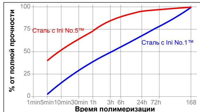
Нижеприведенный график показывает время набора прочности на сдвиг на ПВХ соединений внахлест; испытания проводились по стандарту ISO 4587
